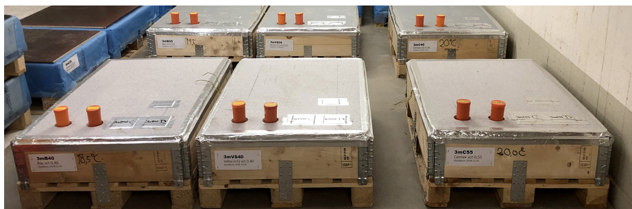
Figur 7: Pågående konceptverifiering inom SBUF 13560 där golvkonstruktioner med olika varianter av modern tät betong i kombination med avjämning och limmad matta testas. Avjämning och limning av matta utförs vid en RF i betongen som överstiger dagens uttorkningskrav.
